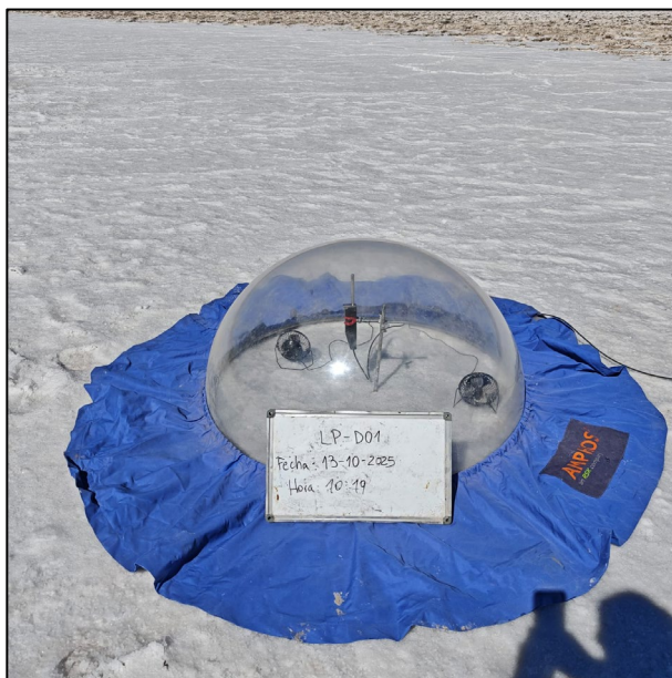
Figura 3-8: Ensayo de evaporación en domo del punto LP-D01, ubicado en el salar de Las Parinas.
