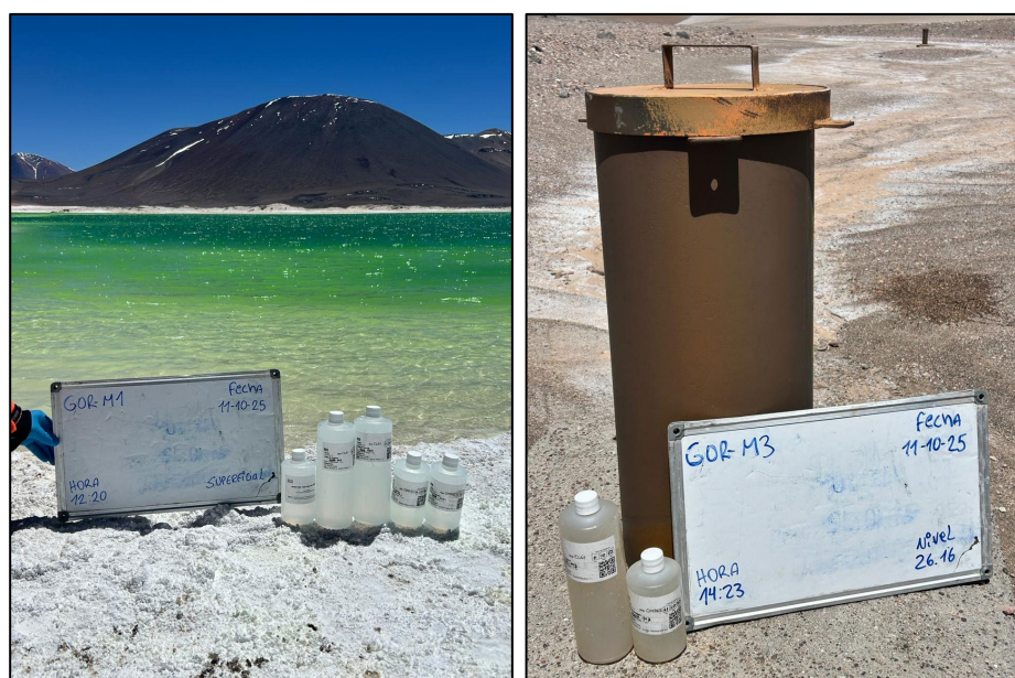
Figura 3-5: Monitoreo hidroquímico en punto de agua superficial y subterránea (GOR-M1 y GOR-M3) del salar de Gorbea.
