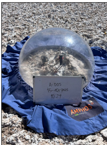
Figura 3-10: Ensayo de evaporación en domo del punto A-D05, ubicado en el salar de Aguilar.
