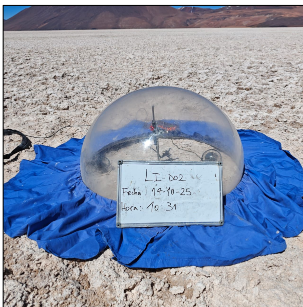
Figura 3-9: Ensayo de evaporación en domo del punto LI-D02, ubicado en el salar de La Isla.
