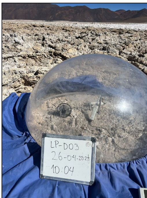
Figura 3-8: Ensayo de evaporación en domo del punto LP-D03, ubicado en el salar de Las Parinas.
