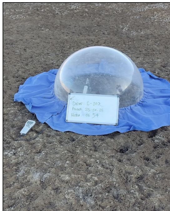
Figura 3-7: Ensayo de evaporación en domo del punto G-D03, ubicado en el salar de Gorbea.
