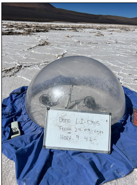
Figura 3-6: Ensayo de evaporación en domo del punto LI-D05, ubicado en el salar de La Isla.
