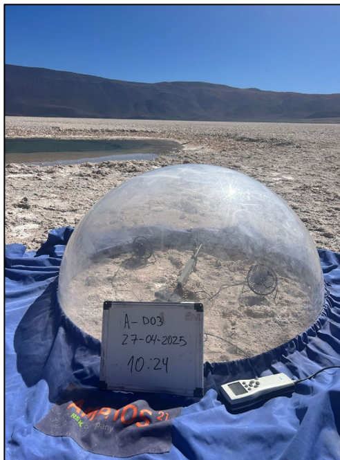
Figura 3-9: Ensayo de evaporación en domo del punto A-D03, ubicado en el salar de Aguilar.
