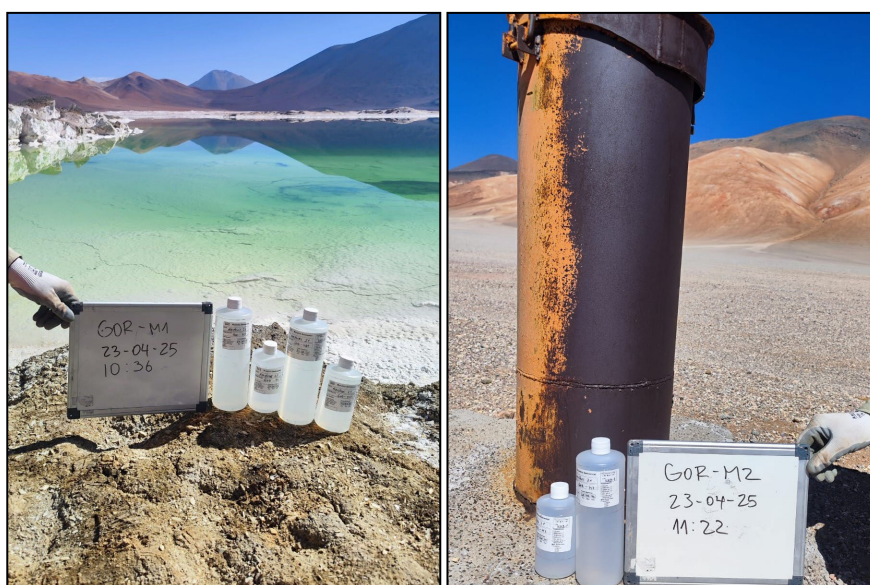
Figura 3-4: Monitoreo hidroquímico en punto de agua superficial y subterránea (GOR-M1 y GOR-M2) del salar de Gorbea.
