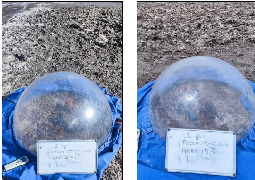
Figura 3-3: Ensayo de evaporación en domo del punto LI-D04, ubicado en el salar de La Isla.
