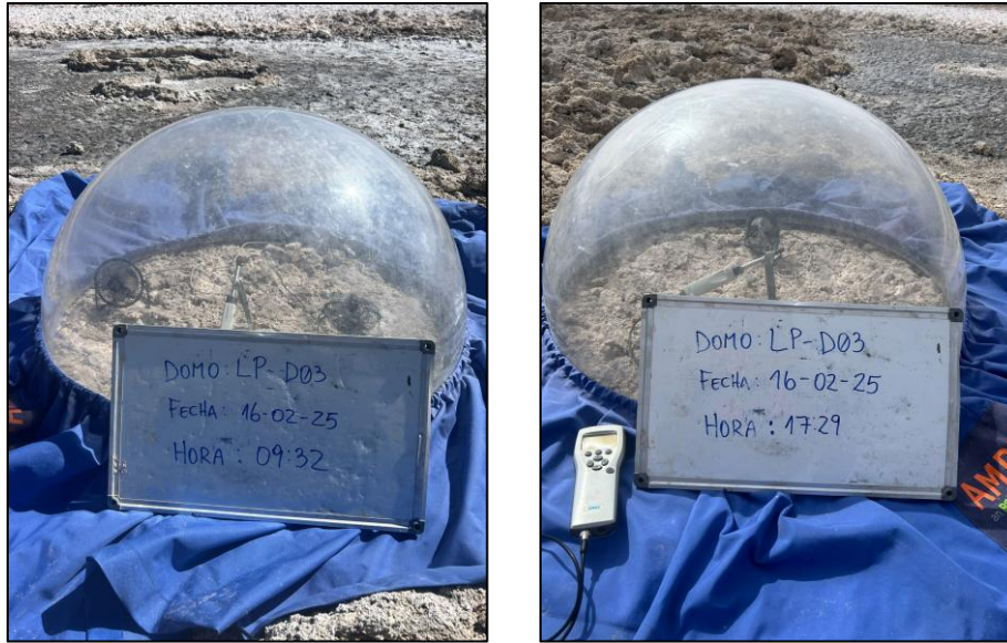
Figura 3-4: Ensayo de evaporación en domo del punto LP-D03, ubicado en el salar de Las Parinas.
