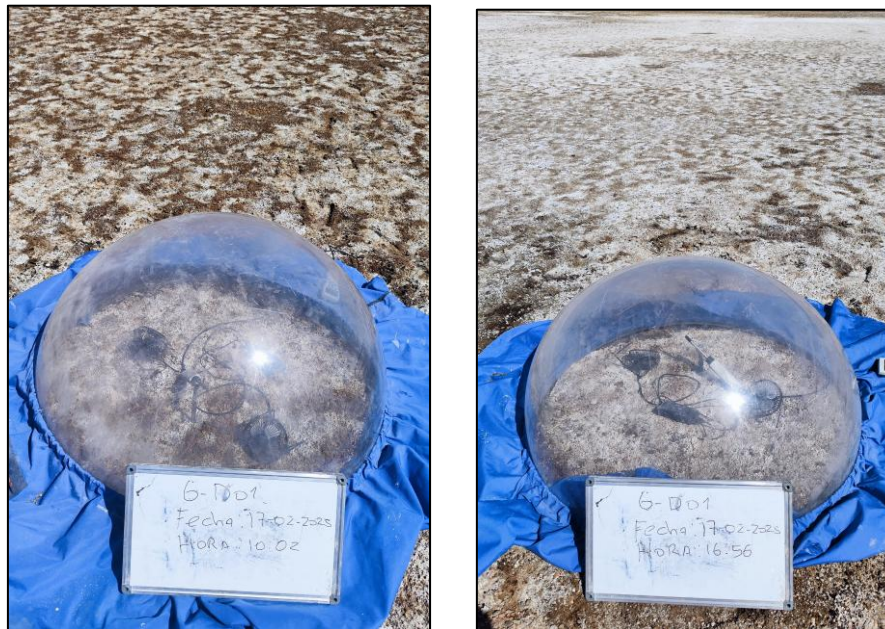
Figura 3-5: Ensayo de evaporación en domo del punto G-D01, ubicado en el salar de Gorbea.
