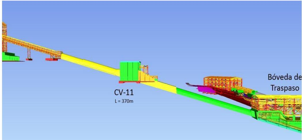
Figura 6: Sección longitudinal extensión correa CV-11
