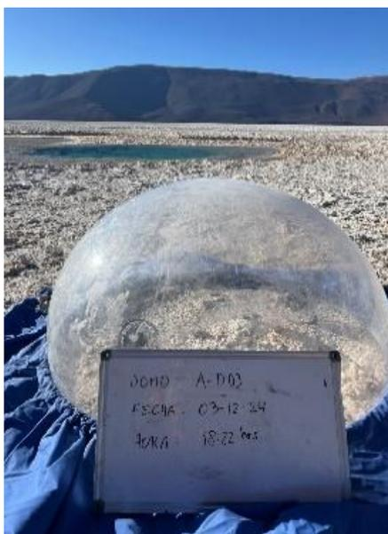
**Figura 3–3:** Ensayo de evaporación en domo del punto A-D03 ubicado en el salar de Aguilar.
