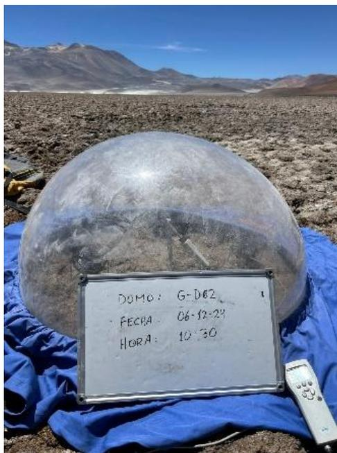
**Figura 3-6:** Ensayo de evaporación en domo del punto G-D02 ubicado en el salar de Gorbea.
