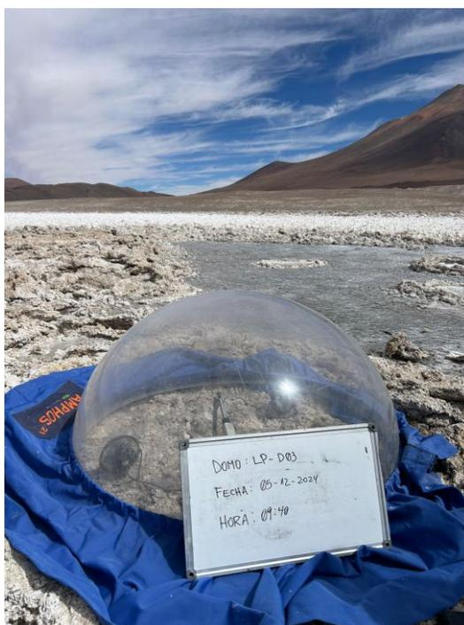
**Figura 3–5:** Ensayo de evaporación en domo del punto LP-D03 ubicado en el salar de Las Parinas.
