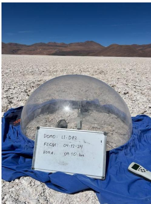
**Figura 3–4:** Ensayo de evaporación en domo del punto LI-D02 ubicado en el salar de La Isla.
