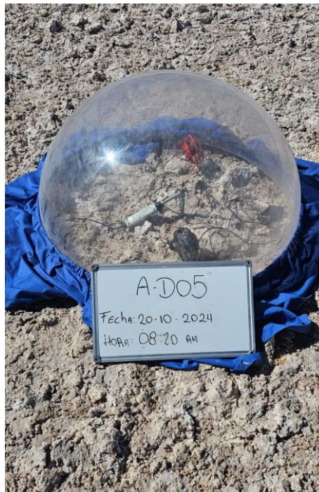
Figura 3-5: Ensayo de evaporación en domo del punto A-D05 ubicado en el salar de Aguilar.
