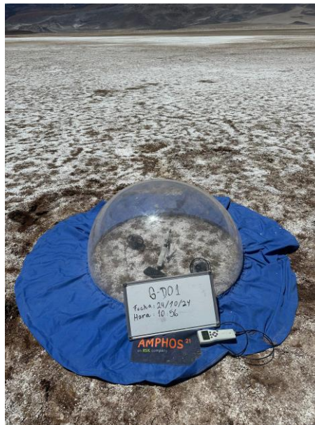
Figura 3-9: Ensayo de evaporación en domo del punto G-D01 ubicado en el salar de Gorbea.
