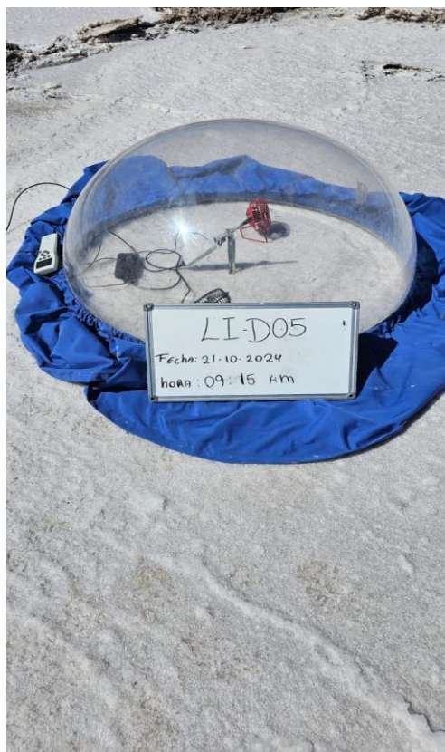
Figura 3-6: Ensayo de evaporación en domo del punto LI-D05 ubicado en el salar de La Isla.
