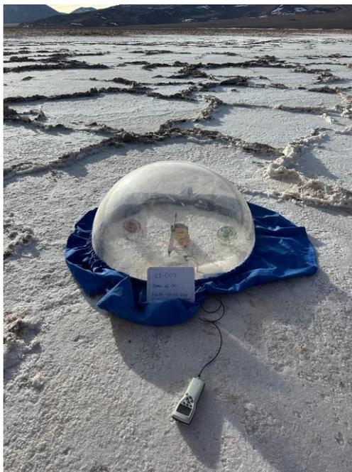
**Figura 3-9:** Ensayo de evaporación en domo del punto LI-D05 ubicado en el salar de La Isla.
