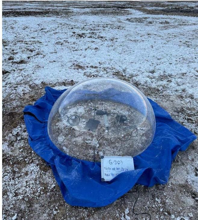
**Figura 3-3:** Ensayo de evaporación en domo del punto G-D03 ubicado en el salar de Gorbea.
