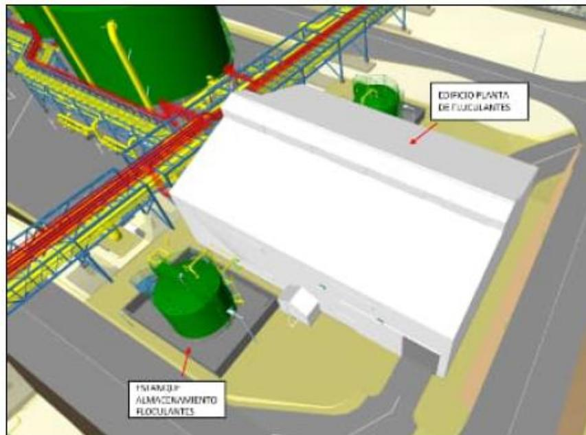
Figura 2-15: Planta de Floculantes.
