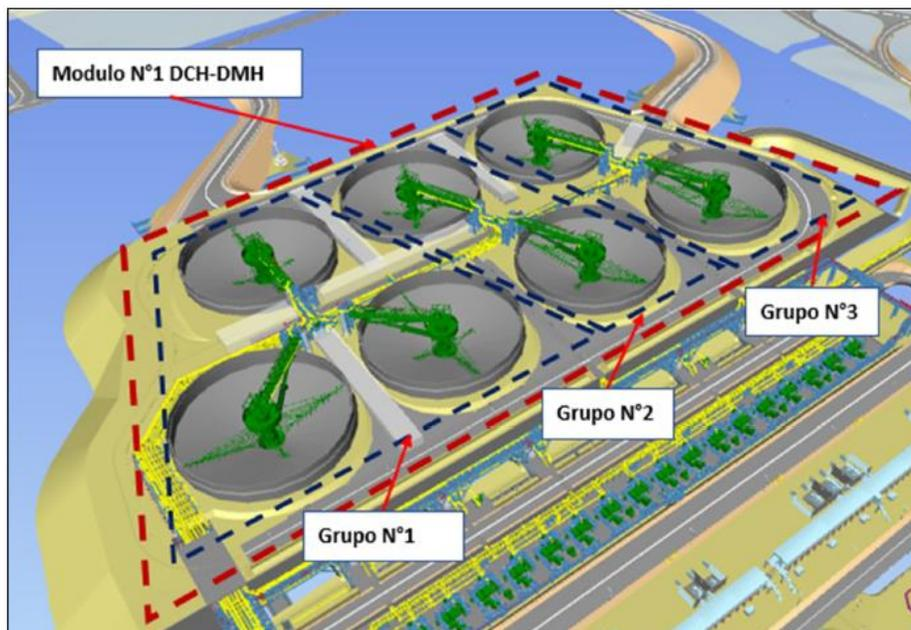
Figura 2-5: Paquetes de Trabajo Espesadores Alta Densidad.
