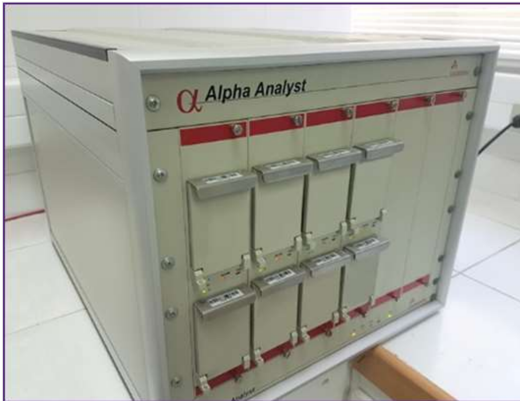
Figura 9. Espectrómetro Alfa. Sistema de cuantificación de radionúclidos.
