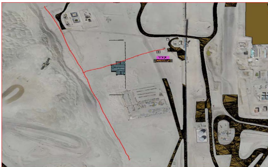
Figura N°4: Líneas aéreas de 23 kV a retirar
