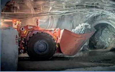
**INNOVACIÓN.**—La mina subterránea —que ya comenzó a funcionar— dispone de una “Pala LHD”, que permite extraer el mineral desde los macrobloques, para llevarlos hacia la trituradora de Chuquicamata Subterránea. “Cuenta con tecnología de punta que permitirá a los operadores controlar los equipos telecomandados desde estaciones en la superficie”, explica Pizarro.
