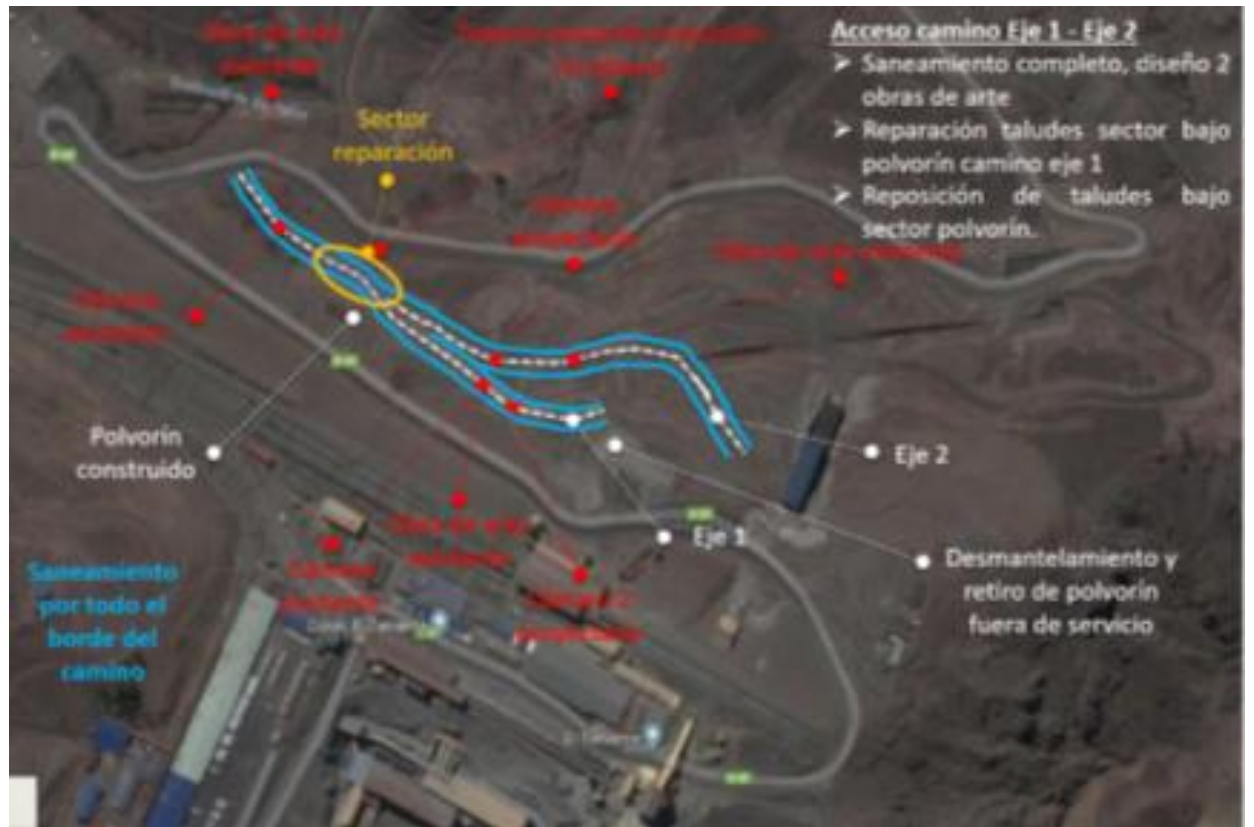
Figura N°5: Ejemplo de alcance en saneamiento de caminos.
