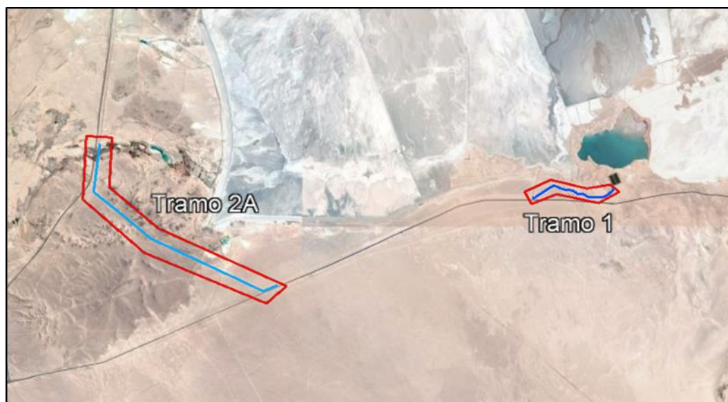
Figura 2. Tramos refuerzo Aducción Talabre
