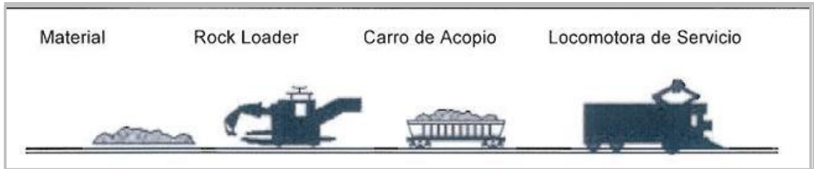
Figura 1: Configuración operacional del Equipo Limpiavías.
