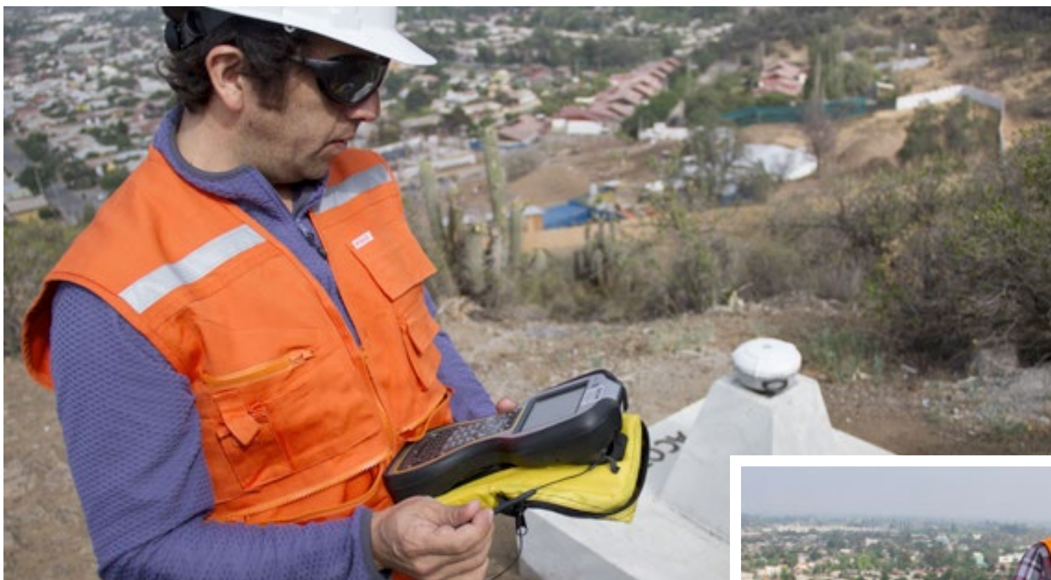
El sistema de mediciones es certificado por el Instituto Geográfico Militar y materializado a través de 12 vértices o puntos de localización y dos estaciones activas.
