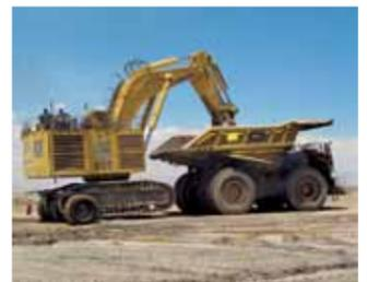
La División Ministro Hales acaba de estrenar un nuevo equipo -único en Chile- utilizado para optimizar el trabajo en faena. Se trata del Sleipner, máquina compuesta por un conjunto de ruedas unidas por un eje y que sirve para el transporte de palas hidráulicas no mayores a 350 toneladas.
