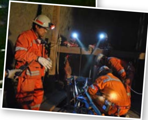
Un primer contingente de mineros de la División trabajaron en el interior de la mina, fortificando la rampa de acceso y tratando de bajar a los niveles inferiores a través de la chimenea de ventilación que se observa en la imagen.
