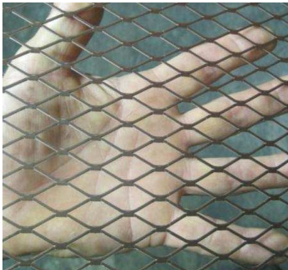
Expanded strip 74% open area, 1mm thick 90/10 Cu-Ni 拉伸网，74%为网目空间，1毫米厚，90/10铜镍合金
