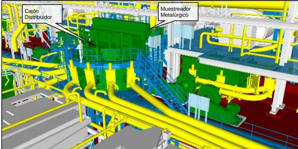
Figura 9: Modelo 3D Cajón Distribuidor Flotación Rougher – Área Flotación Colectiva
