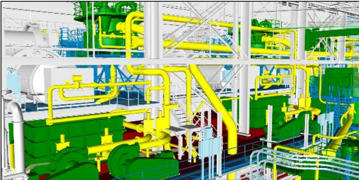
Figura 7: Modelo 3D Sistema de Impulsión a Baterías de Hidrociclones – Área Molienda
