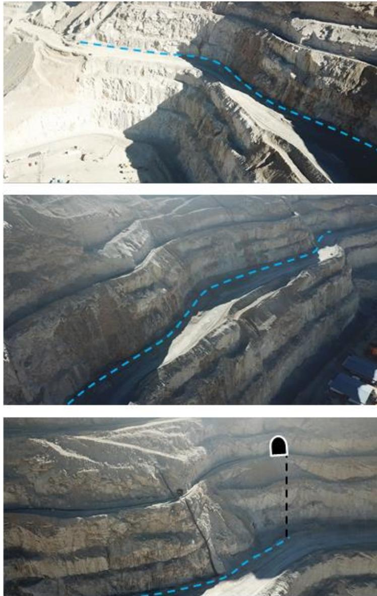
Figura 11: Trazado tubería HDPE 450mm desde inicio banco 3580 (línea segmentada azul) hasta llegada a subida a banco 3628 (línea segmentada negra tubería PE-X) e inicio nuevo túnel
