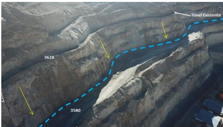
Figura 4: Sector de saneamiento (trazas en amarillo) para montaje de tubería en banco 3580 (línea segmentada en azul).
