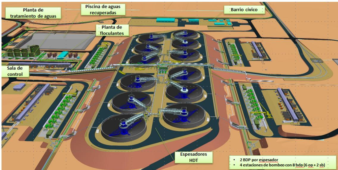
Figura 4. Planta de Espesadores Alta Densidad PEAD
