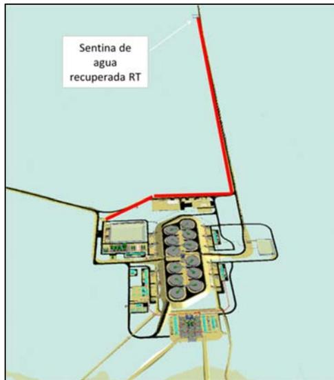
Figura 8. Trazado Impulsión de Agua a Sentina RT
