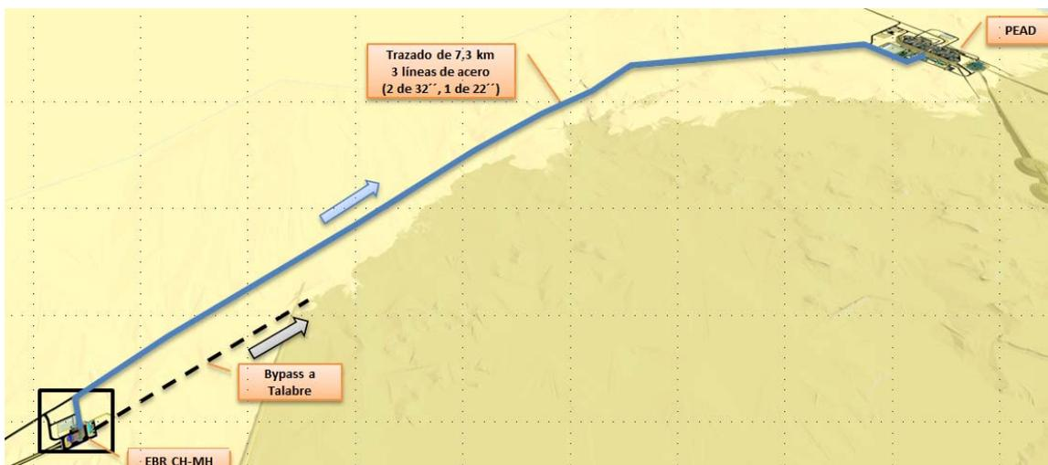
Figura 2: Esquema Sistema de Transporte de relaves
