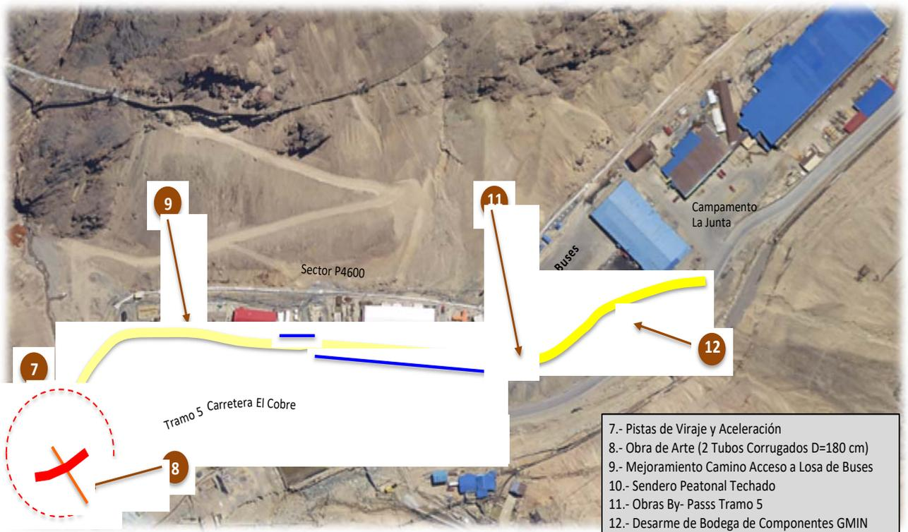
**Figura N°2:** Esquemas con el alcance general referencial de las obras que deberá ejecutar el Contrato (alcance referencial del Contrato).
