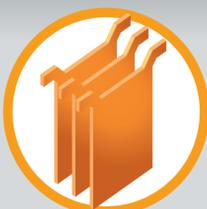
**Ánodo:** Entre un 98% y 99,5% de pureza. Tiene un peso entre 225 y 260 kg.
