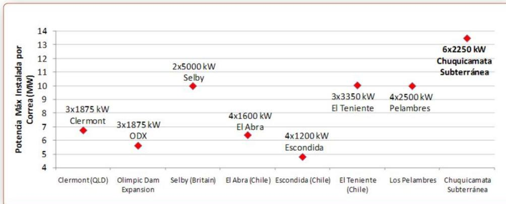
Figura N° 25: Potencia máxima instalada por correa
