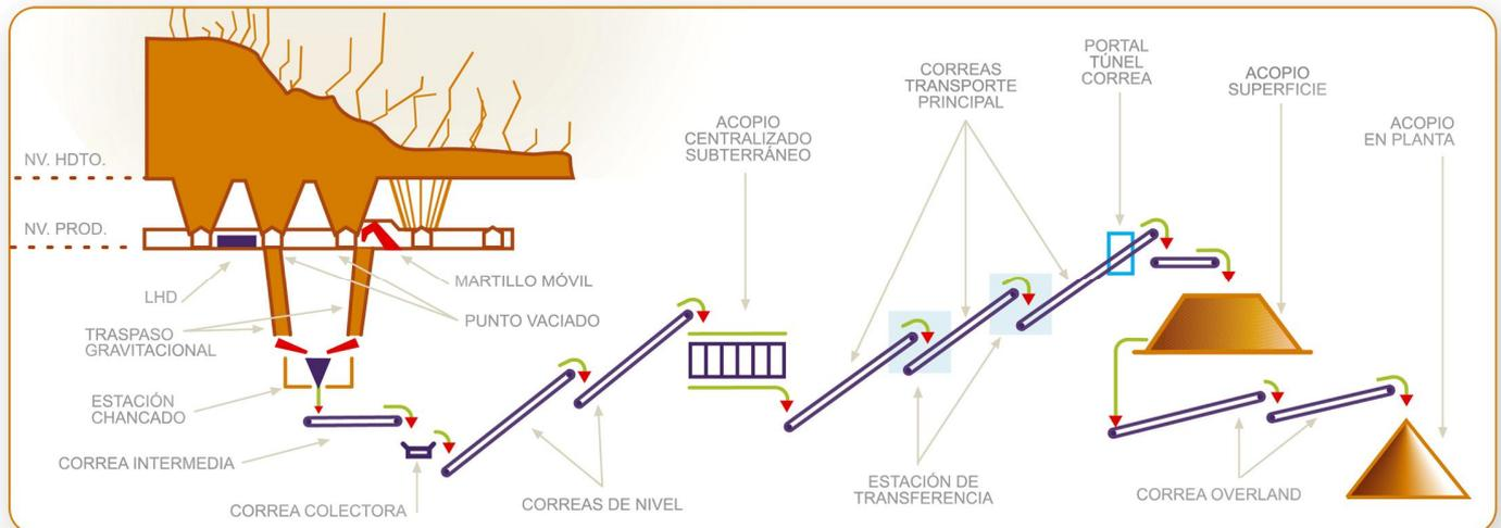
Figura N° 20: Perfil Esquemático del Sistema de Manejo de Materiales
