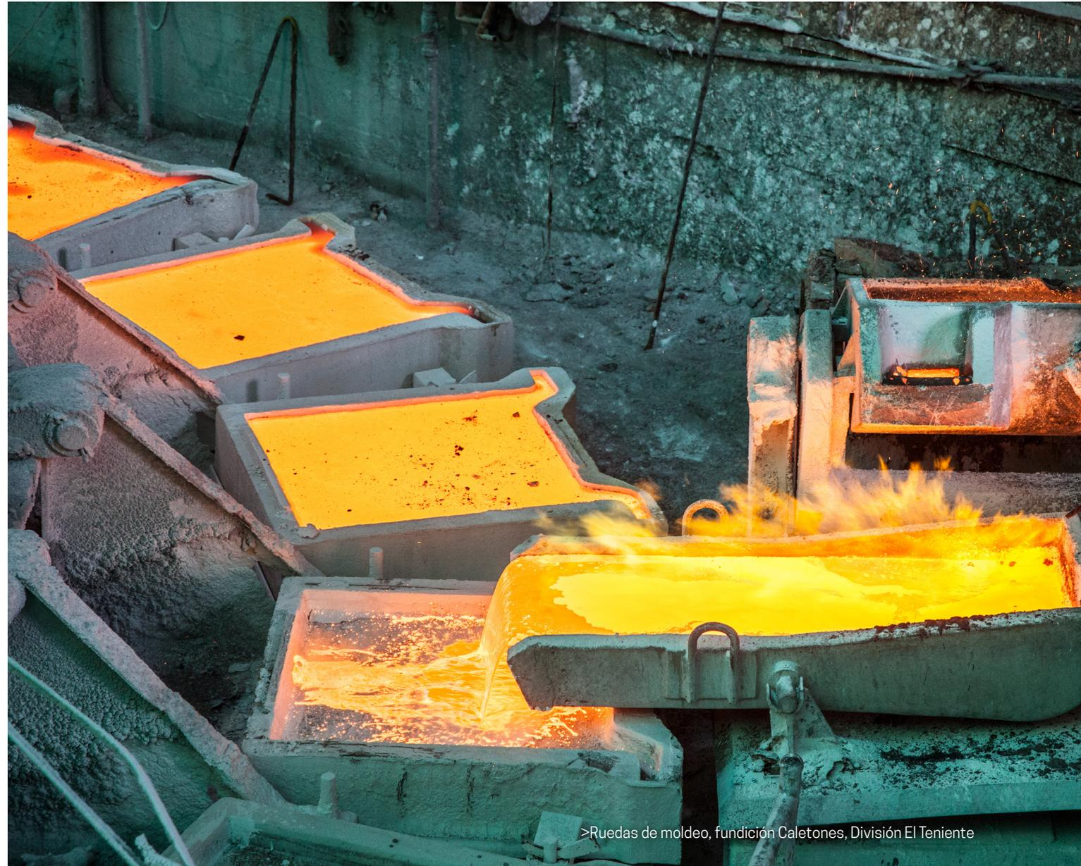
>Ruedas de moldeo, fundición Caletones, División El Teniente
