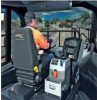
**Entrenamientos de inmersión de Operarios en tiempo real** Acelera el entrenamiento simulando condiciones operacionales anormales y permitiendo la interacción segura del operario
