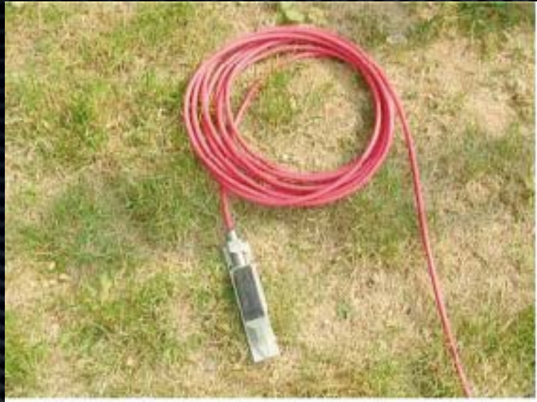
Sensor Nivel Agua Alcantarillas
