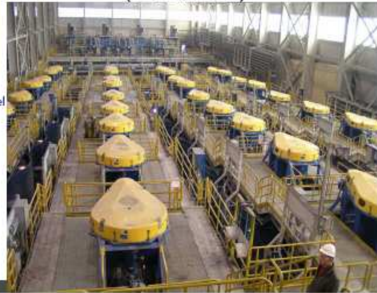
Escondida: Instalación en la Flotación Primaria Líneas 1,2,3,4,5,6 (54 Camaras)
