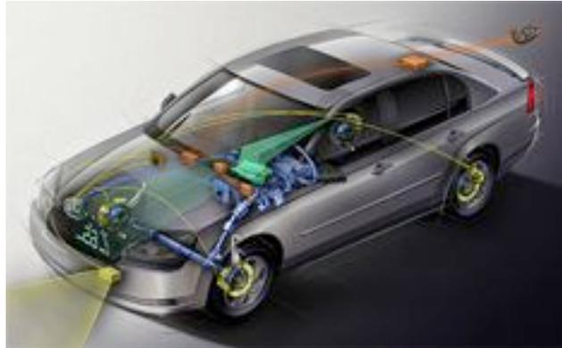
Un automóvil moderno contiene más de 50 ECU (Electronic Control Units) conectadas por un bus especializado (ej. CAN Bus). Ejemplos de ECUs:
