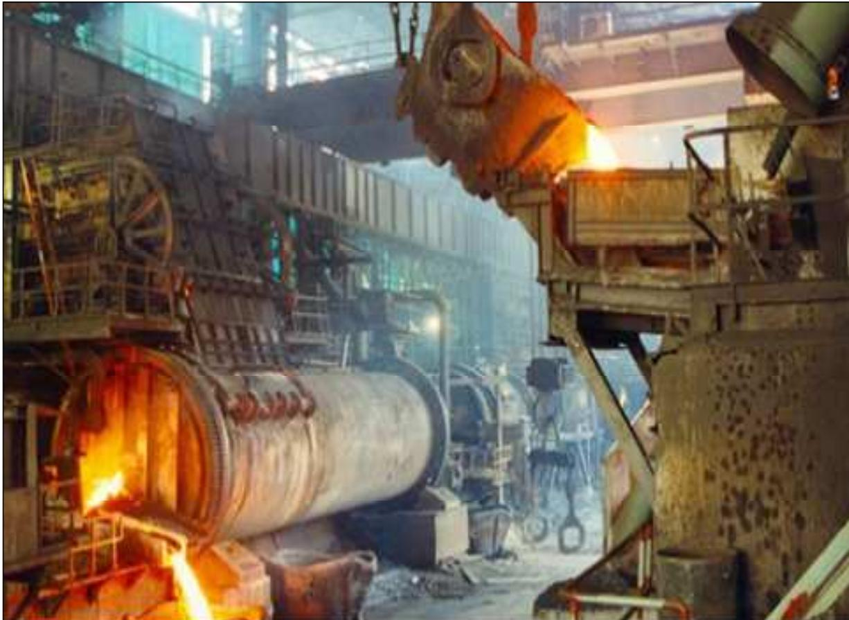
Al detener la operación, el reactor de fusión debe girar de su “posición de soplado”. Para tal efecto, es necesario previamente abrir la “tapa o compuerta de la campana de gases”, lo que genera una emanación de gases a baja altura.
